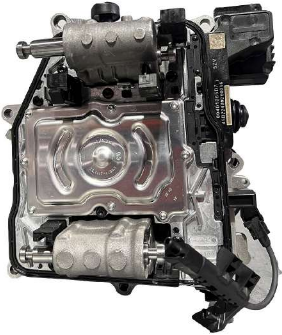
ETAPE 8 : Remonter le TCU sur le bloc hydraulique
