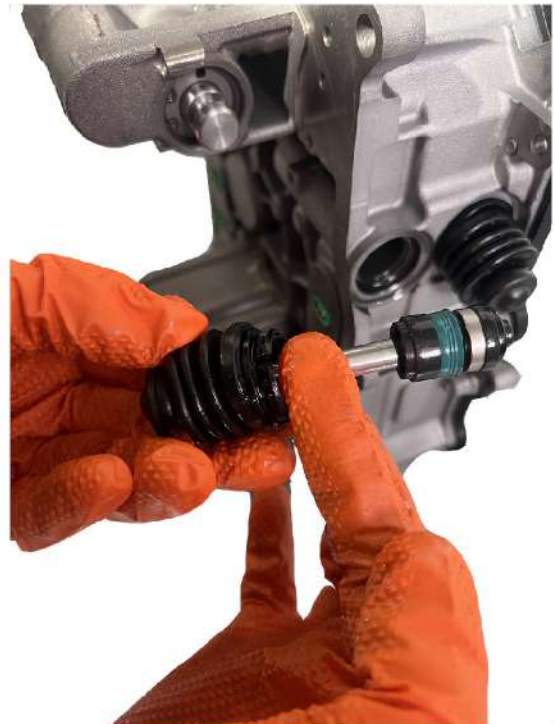
ETAPE 4 : Changer les soufflets par les neufs Remettre le support sur les soufflets neufs et changer les joints verts puis mettre en place sur les pistons.
