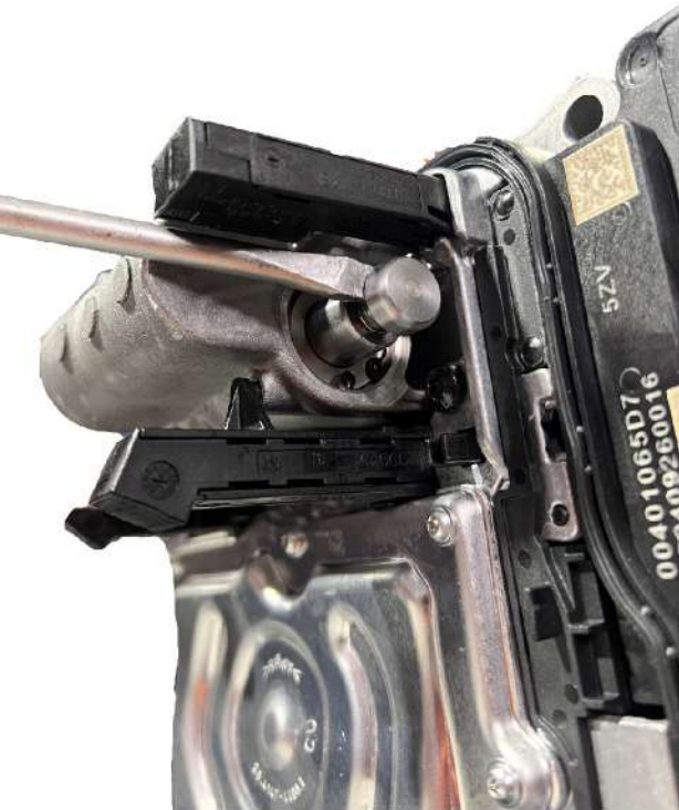
ETAPE 10 : Actionner les 6 pistons d'avant en arriere, pour les remplir d'huile.
