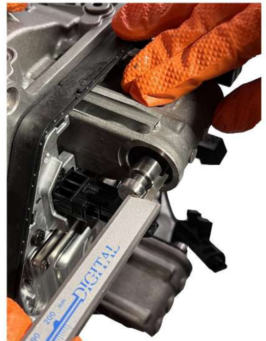
ETAPE 11 : Regler les actionneurs des fourchettes à 2.5cm puis remonter sur le véhicule.
