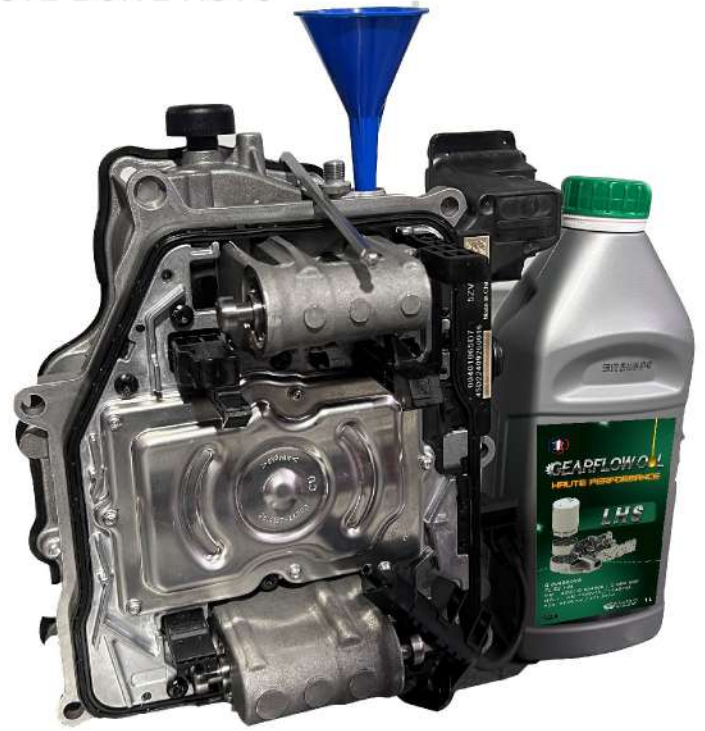
ETAPE 9 : Procéder au remplissage du bloc hydraulique avec un petit entonnoir, verser 1L d'huile Multi HF ou équivalent.
